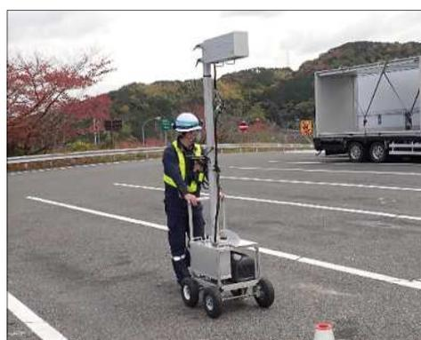
ひび割れ測定システム
