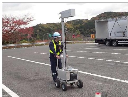
ひび割れ測定システム
